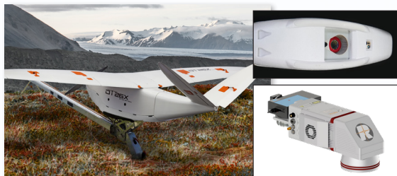
Пример интеграции самолёта со сканером RIEGL miniVUX-1DL LiDAR с инерциальной системой APX-15 UAV
