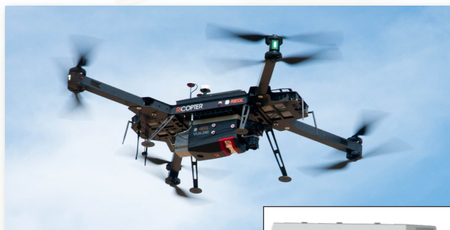
полностью интегрированный мультикоптер RiCOPTER со сканером RIEGL VUX-240 и инерциальной системой APX-20 UAV
