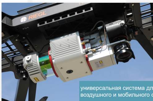
сканер RIEGL VUX-1UAV с инерциальной APX-20 UAV, тепловизионной камерой Flir Tau 2 и камерой Sony Alpha 7R III
