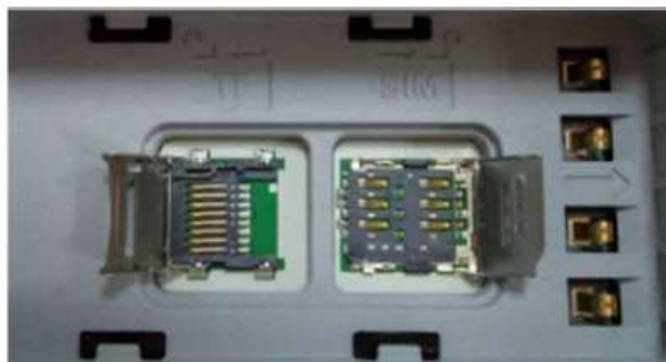
Рисунок 3.1. Слоты для MicroSD и Sim-карты (в открытом состоянии слева и в закрытом состоянии на картинке справа)
