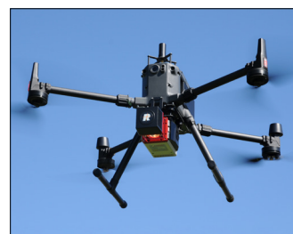
DJI Matrice M300 RTK оснащен системой RIEGL miniVUX-SYS с использованием RIEGL Integration Kit 300
