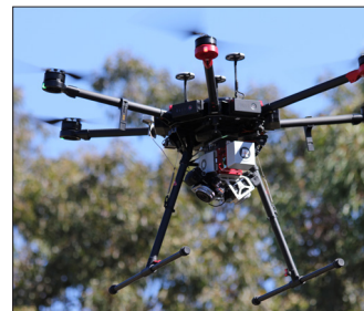
DJI Matrice M600 оснащен системой RIEGL miniVUX-SYS с использованием RIEGL Integration Kit 600
